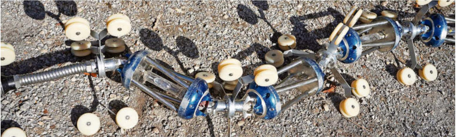
Diese Lichterkette härtet den Kunstharzschlauch von innen aus. Sie wird vom Roboter durch das Rohr gezogen. Foto: Fiorella Koch
